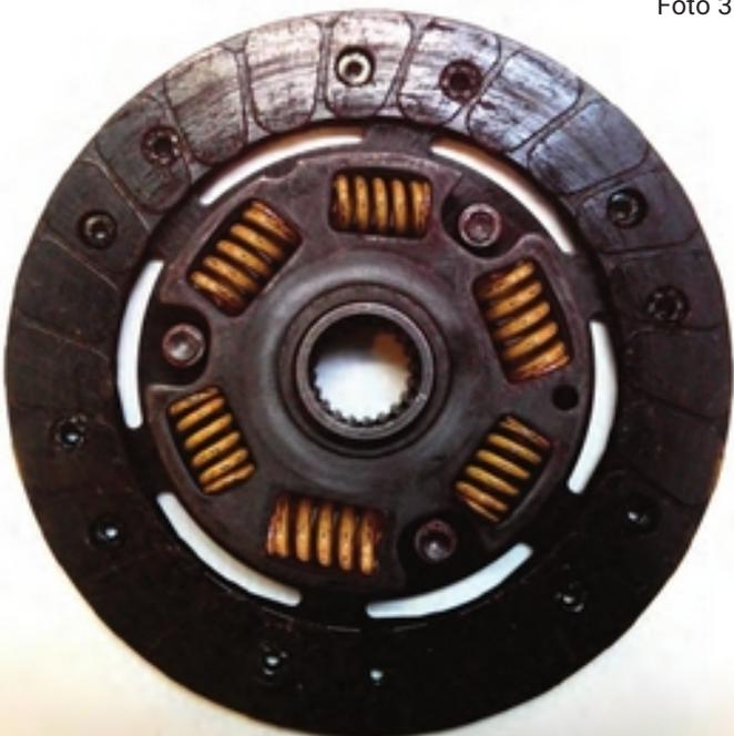
assiale, per liberare il disco condotto. Le facce del volano e del complessivo, in questo caso sono conduttori e premono sul disco guarnito che, al contrario della frizione multidisco, è quello condotto. Il materiale d'attrito è rivettato alle due facce del sottile disco in acciaio. Il complessivo è calettato per mezzo di un profilo scanalato all'albero che sporge
