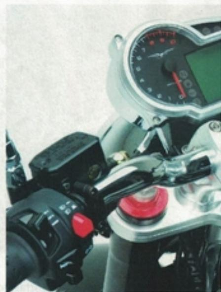
danni alle guarnizioni, bisogna sempre rispettare le indicazioni apposte sul serbatoio del liquido freni. Una scritta in inglese "Use only DOT#" indica senza dubbio il tipo di liquido ammesso nel circuito.
