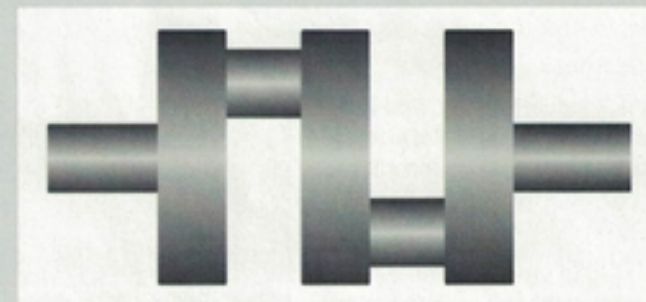
Fig.4. Schema albero motore per un motore bicilindrico boxer o un bicilindrico parallelo con manovelle a 180^\circ .
