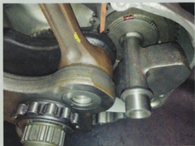
Fig.8. Il contralbero di equilibratura passa a pochi millimetri da biella e albero motore.
