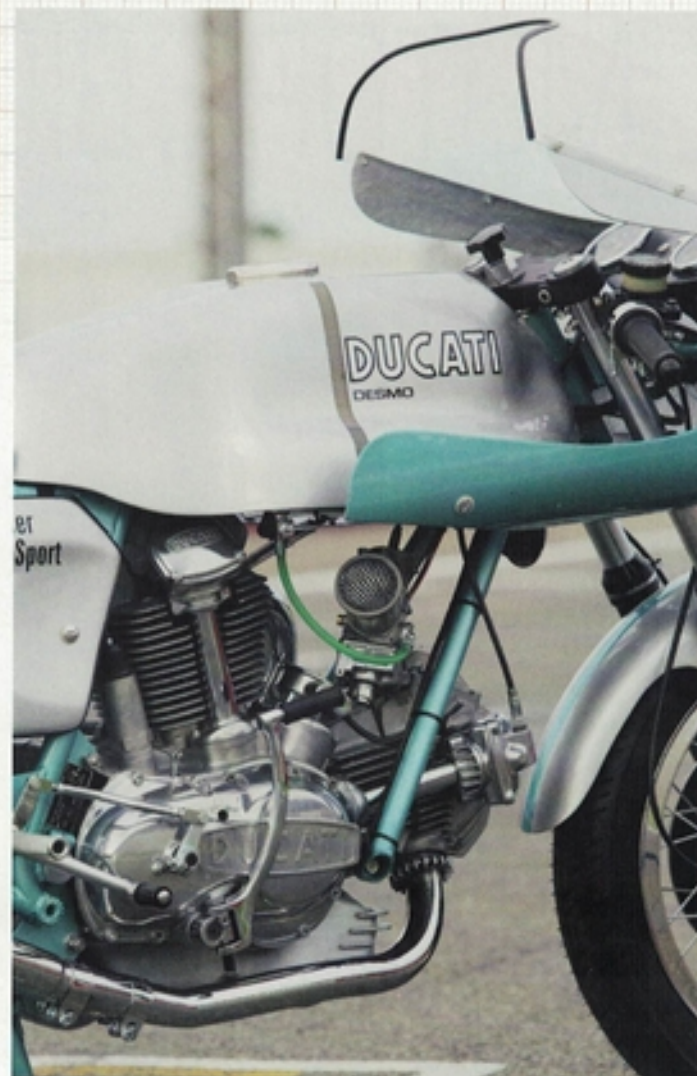
Il motore Ducati è un V di 90° disposto col cilindro anteriore quasi orizzontale. Per questo è stato definito 'a L'.
