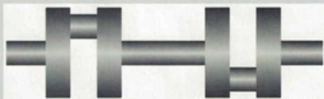
Fig.3. Schema albero motore per bicilindrico in linea (2 e 4 tempi con terzo supporto centrale). E' evidente il maggiore ingombro in senso trasversale.
