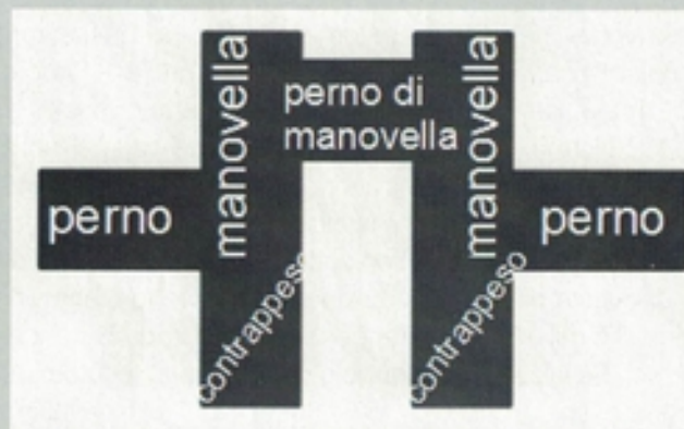
Schema albero motore per monocilindrico con nomenclatura delle varie parti.
