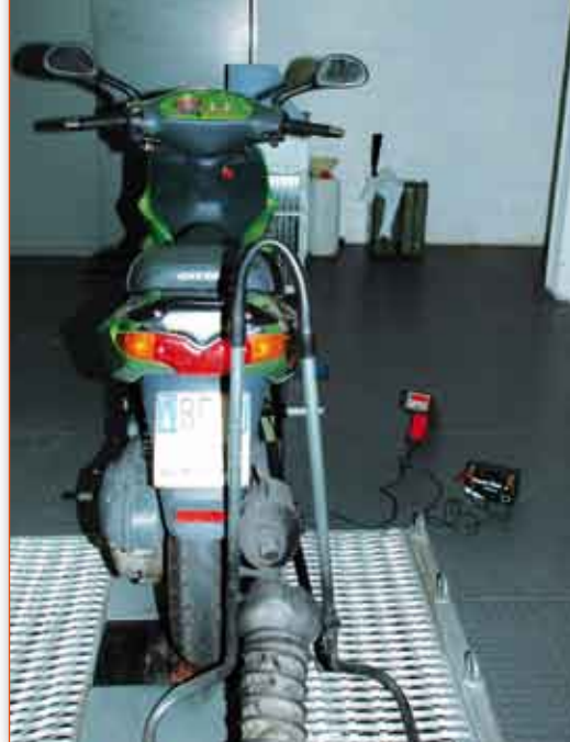
● Per eseguire correttamente le prove e parificare esattamente il numero di giri del rullo e quelli del motore in assenza di un contagiri, abbiamo impiegato una comune pistola stroboscopica digitale.
