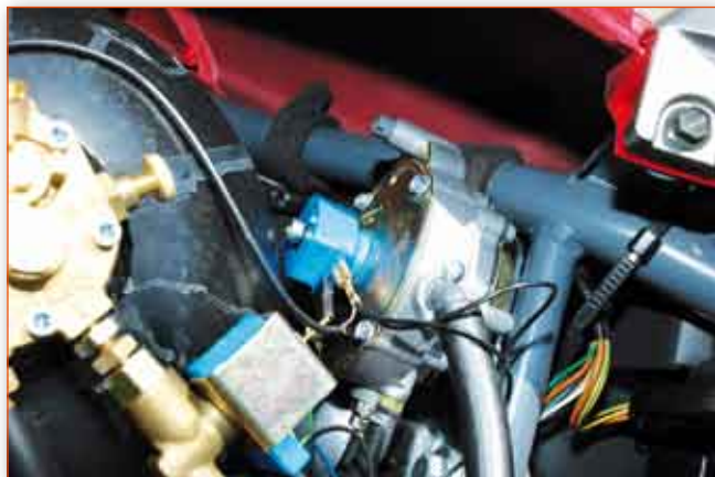
Questo invece è il riduttore di pressione, che abbassa la pressione del gas dagli 8 - 10 bar della bombola a 1 bar necessario al motore e ne regola l'erogazione in funzione della depressione generata dal motore.
