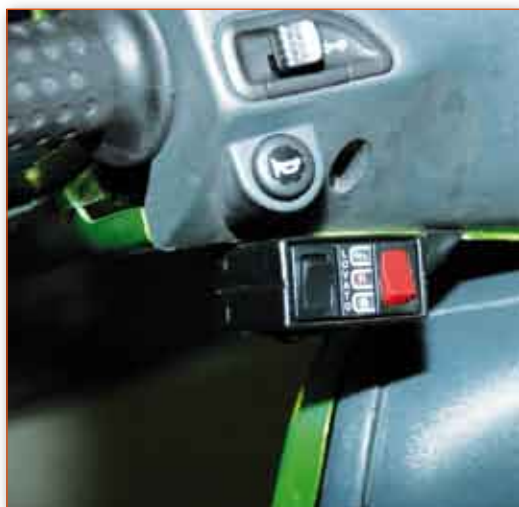
● Questo è il commutatore GPL/benzina, comodamente fissato sotto il manubrio. Il pulsante rosso serve a dare il "cicchetto" per le partenze a freddo.
