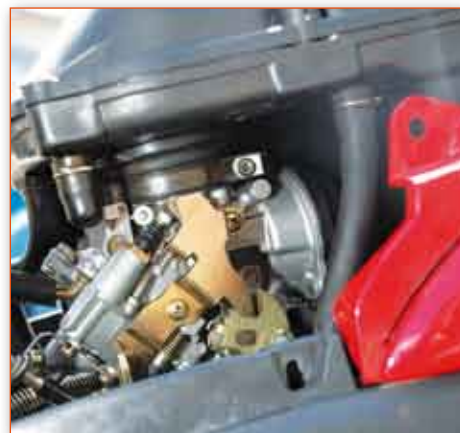
Nel caso dell'Epicuro, lo spazio tra carburatore e scatola filtro non è sufficiente per accogliere il miscelatore. Quest'ultimo di conseguenza è all'interno dell'airbox. Quello ritratto in foto è il prototipo nesso a punto dalla collaborazione tra Lovato e Bikestaff.
