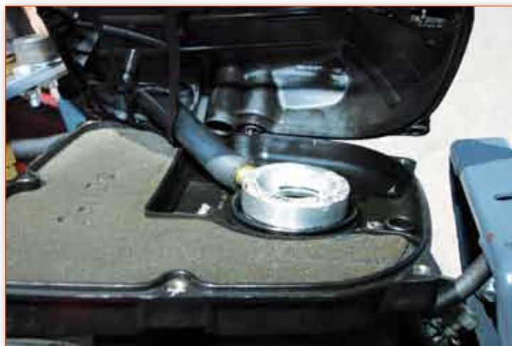
Nel caso dell'Epicuro, lo spazio tra carburatore e scatola filtro non è sufficiente per accogliere il miscelatore. Quest'ultimo di conseguenza è all'interno dell'airbox. Quello ritratto in foto è il prototipo nesso a punto dalla collaborazione tra Lovato e Bikestaff.
