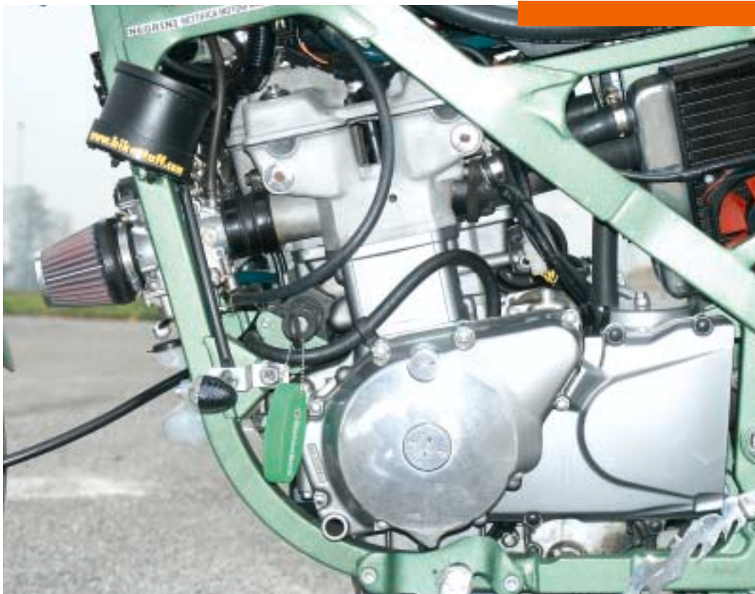
Il motore visto da sinistra. Il basamento è della ER-5, mentre la testata è quella originale della GPZ di partenza. Si noti che dalla testa sono state asportate le alettature di raffreddamento. In basso, il blocchetto elettrico prelevato da un'Aprilia AF1 125.
