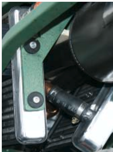
Il motore visto da sinistra. Il basamento è della ER-5, mentre la testata è quella originale della GPZ di partenza. Si noti che dalla testa sono state asportate le alettature di raffreddamento. In basso, il blocchetto elettrico prelevato da un'Aprilia AF1 125.
