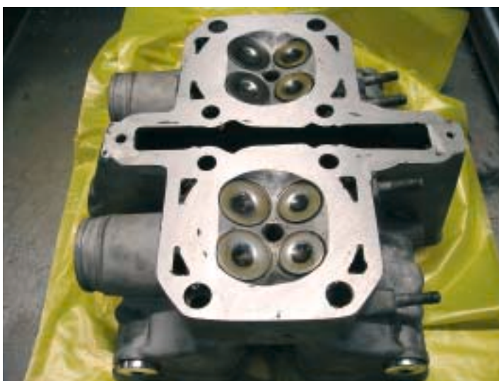
La testata del motore GPZ 500 appena smontata e durante le lavorazioni che hanno portato alla sua inversione.
