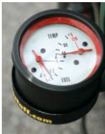
La strumentazione, sempre dell'Aprilia 125, è stata divisa in due elementi montati ai due lati del motore. Non è previsto il contagiri.
