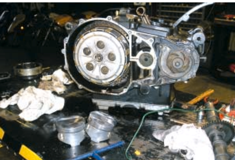
Il fattaccio: quando hanno aperto il basamento del GPZ, i nostri amici hanno trovato l'albero motore spezzato a metà... meglio buttare tutto e partire da un blocco motore più nuovo.
