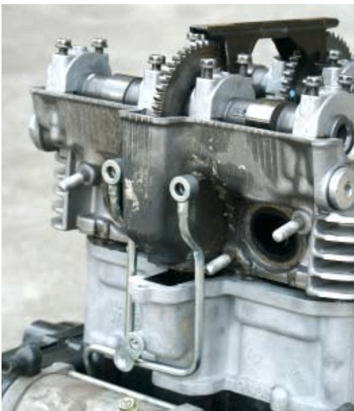
Abbiamo preso la testata della ER-5 inutilizzata e l'abbiamo appoggiata sui resti del motore GPZ originale. Nella prima foto la vediamo montata come in origine, mentre nella seconda ci si rende facilmente conto di quanto materiale mancasse ed è stato ricostruito.
