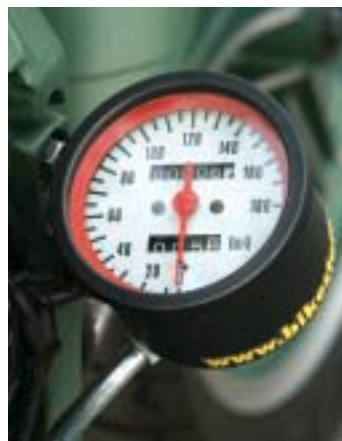
La strumentazione, sempre dell'Aprilia 125, è stata divisa in due elementi montati ai due lati del motore. Non è previsto il contagiri.
