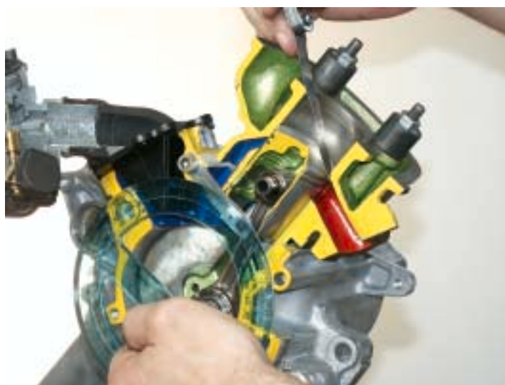
Le operazioni da eseguire per determinare il time area di scarico sono le medesime del caso precedente. La differenza è che lo spessimetro deve essere posizionato nella parte superiore della luce di scarico.
